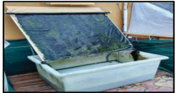
चित्र-1 : बाहरी वातावरण में नगरपालिका अपशिष्ट जल में शैवाल बायोमास की खेती के लिए संलग्न बायोफिल्म रिएक्टर (ए.बी.आर.)
